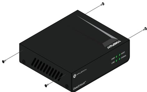
2. Coloque uno de los soportes de montaje, como se muestra a continuación, alineando los agujeros en el lado de la caja con un conjunto de agujeros en el soporte de montaje.
